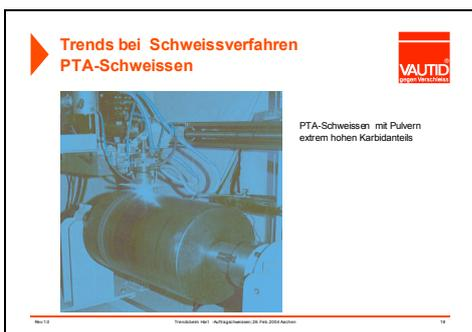
hat seinen Siegeszug beim Panzern von Ventilen für die Autoindustrie errungen. Es wurde damit eine mechanisierte Panzerung im Dauerbetrieb erreicht, mit geringsten Vermischungen und guten Oberflächengüten, wodurch sich der Materialverbrauch gegenüber stranggegossenen Stäben wie sie früher verwendet wurden, halbierte.
