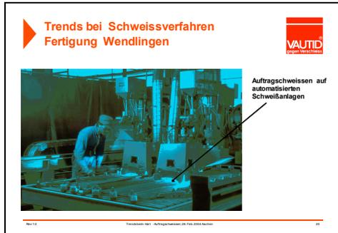
eingesetzt. Solche Platten mit Vielbrennertechnik und hohen Abschmelzleistungen lassen sich weit wirtschaftlicher herstellen, als selbst zu panzern.
