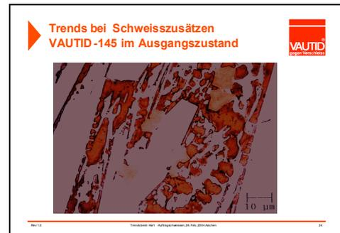
In beschränktem Umfang kann man solche Werkstoffe auch für höhere Temperaturen bis ca. 750 °C einsetzen, danach verlieren sie aber wegen Gefügeumwandlung bei noch höheren Temperaturen ihre Verschleissbeständigkeit.
