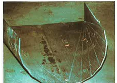
Bild 7: Übergangsstück aus Verschleißverbundplatten konfektioniert
