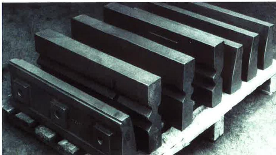
Bild 3: Schlagleisten aus untereutektischem Hartguss
