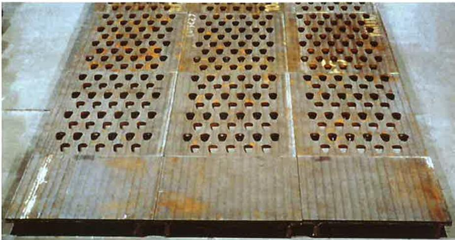
Bild 5: Siebbelag aus V100-Verbundplatten
