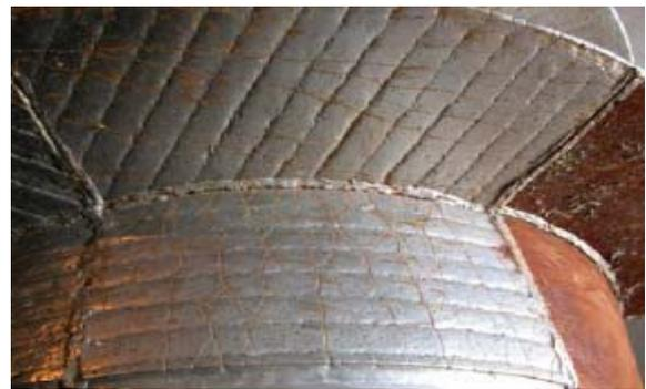
Bild 24: Verschleißplatte nach über 1.000 h im Einsatz
