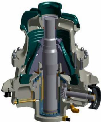
Bild 9: Schnitt durch eine Kegelbrecherkonstruktion
