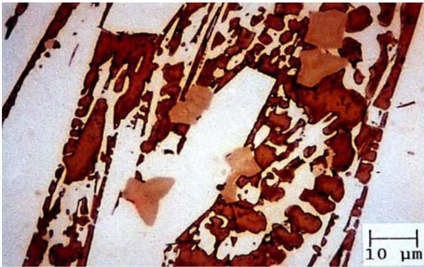
Bild 17: Lichtmikroskopische Analyse des Auftragsschweißwerkstoffs mit W-, V- und Nb-Sonderkarbiden zur Anwendung bei erhöhter Temperatur
