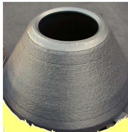
Bild 11: Auftraggeschweißtes Werkzeug eines Kegelbrechers
