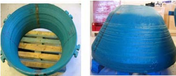
Bild 13: Gepanzerter Satz Kegelbrecher vor dem Einbau
