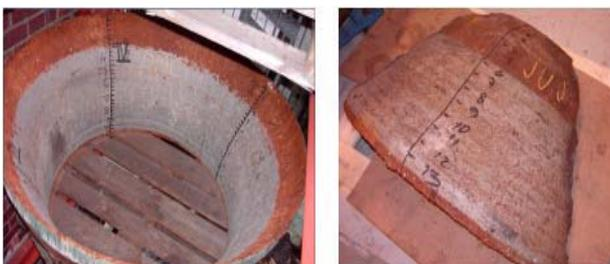
Bild 14: Gepanzerter Satz Kegelbrecher nach dem Einsatz im Steinbruch
