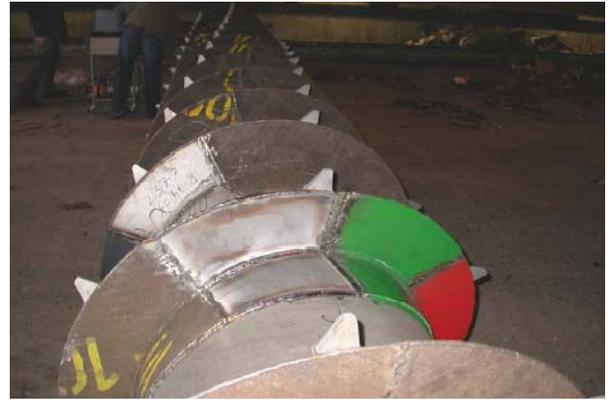
Bild 23: Transportschnecke mit verschiedenen Versuchswerkstoffen
