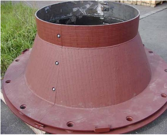
Bild 3: Teile einer Sichterkaskade in der Zementindustrie
