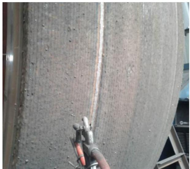
Bild 14: Aufgeschweißte Mahlbandagen mit Fülldraht VAUTID-100
