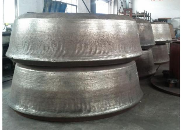
Bild 13: Verschlossene Mahlbandagen ohne Auftragschweißung mit typischem Verschleißbild
