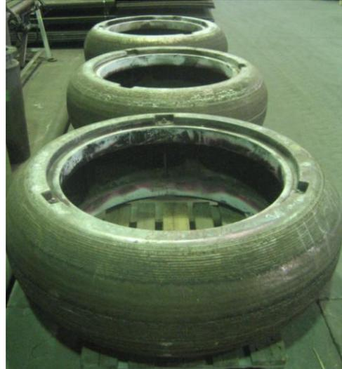
Bild 17: Mahlbandagen mit Auftragsschweißung mit VAUTID-100
