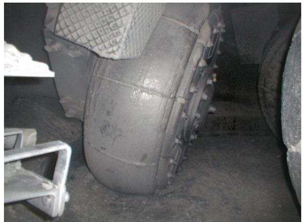
Bild 18: Mahlbandagen mit Auftragsschweißung VAUTID-100 im eingebauten Zustand nach einigen tausend Stunden im Einsatz
