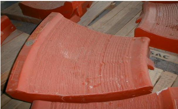
Bild 11: Geliieferte Mahltellersegmente mit Aufschweißung VAUTID-100-Mo
