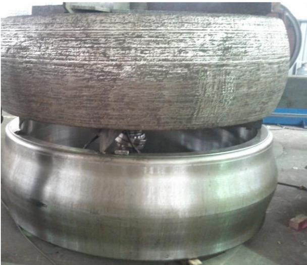
Bild 16: Aufgeschweißte Mahlbandage und Gussgrundkörper vor der Aufschweißung mit VAUTID-100-Mo
