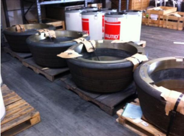
Bild 15: Einbaufertige Mahlbandagen mit Auftragschweißung VAUTID-143
