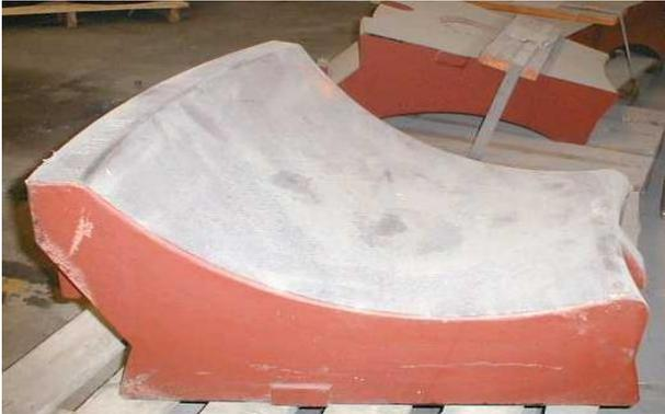
Bild 10: Geliieferte Rohgussteile vor der Aufschweißung
